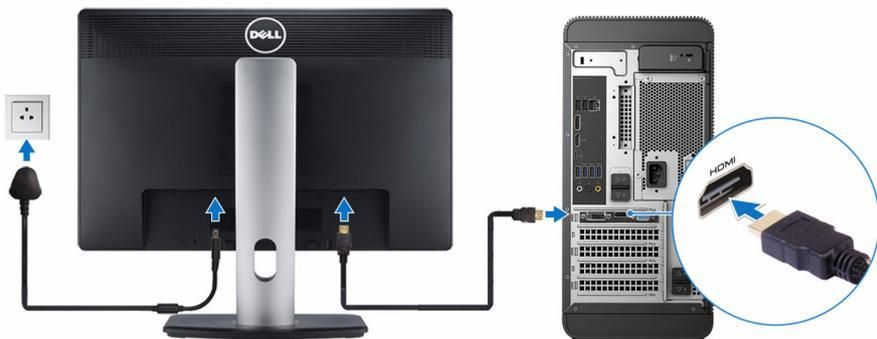
**NOTA:** se o computador tiver sido adquirido com uma placa gráfica dedicada, as portas HDMI e DisplayPort no painel traseiro do computador estarão cobertas. Conecte a tela à placa gráfica dedicada do computador.
